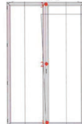
Fig. 6: Assetto sperimentale prova di resistenza al carico del vento: schema di posizionamento dei trasduttori (vista interna)
